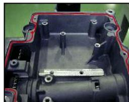
I prodotti Superbond sono speciali adesivi anaerobici ad un solo componente. Sono liquidi che induriscono quando vengono a trovarsi fra due superfici metalliche da collegare, l'aria è l'inibitore: conserva il prodotto liquido, il metallo è il catalizzatore: attiva l'indurimento.
