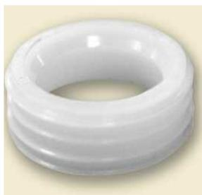
Queste unità sono state progettate per l'utilizzo in zone, dove lo spazio è un problema. L'elemento maschio è composto dal solo "fiore" di tenuta e da una vite che permette al maschio di essere fissato al pannello o al supporto consentendo sempre la regolazione di 4 mm su 360°. L'elemento femmina, denominata "Colpo", è un elemento cilindrico che è pressato in un foro di 30 mm +0,1 +0,3 di diametro.
